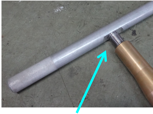
ハンドルを取付けてシャフトを固定する。
