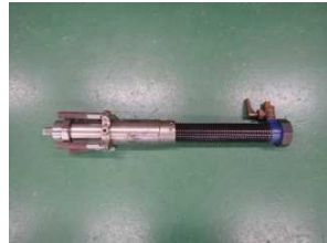
写真8. 穿孔機の送りねじをいっぱいに戻した状態
