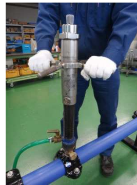
写真11. 穿孔機の送りねじをいっぱいに戻した状態
